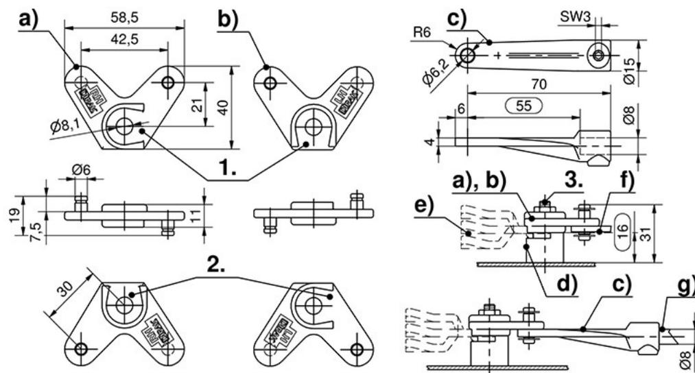
**90° Eckumlenkung für Mehrpunktverriegelung**
